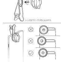
本製品をスマホのカメラの上に取り付けた後、レンズからスマホのカメラをチェックして、 しっかりとカメラの中心に付き合わせることを確認してください。或いは先にクリップをス マホに付けて、後でレンズを慎重にねじ込みます。最後レンズが正しく取り付けるかどうか をテストします(ケラレなくて、ぼんやりしません)。お使いのスマホにケースが付ける場 合は、取り外して試してみてください。
